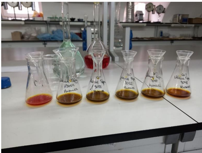
2. ábra A talajminták humusztartalmának meghatározása Tyurin-féle módszer szerint
