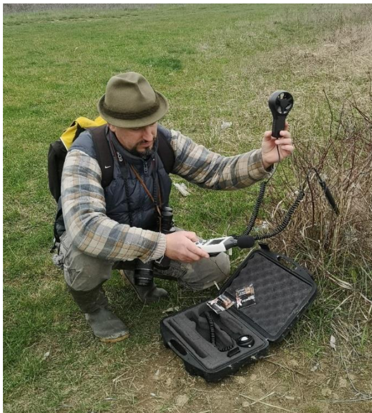
22. ábra. A Flus ET-965 multifunkcionális mérőműszer használata közben a 3. bányató „A” mérési pontjánál (Forrás: Sztankovics Anna-Mária)
